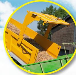
Puerta de gran despeje con junta de estanqueidad
