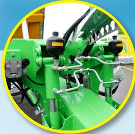
Suspensión hidráulica (lanza y ejes)
